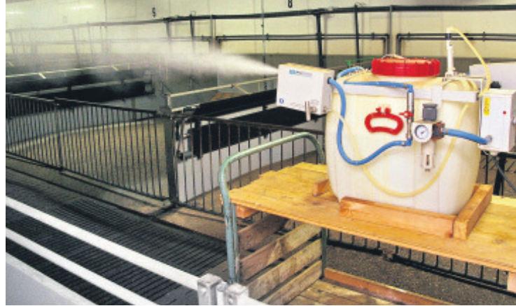
Kaltnebelgerät anstellen und den Stall verlassen. Nach etwa drei Stunden ist das Schweinemastabteil mit dem Gerät Automatic mit zwei Düsen (Wurfweite je rund 50 m) gründlich desinfiziert. FOTOS: SUSANNE GNAUK
